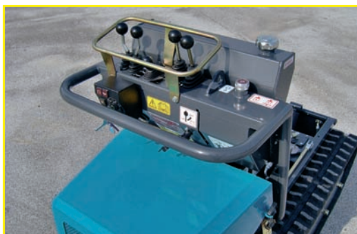
Control levers for the machine travelling and manoeuvring. Fortbewegungssteuerung und Maschinenbetätigung. Рычаги управления движением и маневрированием.
