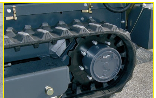
Detail of the planetary drives and multiple disk brakes with negative control system. / Detail Planetengetriebe mit Lamellenbremsen mit negativer Steuerung / Элементы планетарных двигателей и многократных дисковых тормозов с отрицательной системой управления
